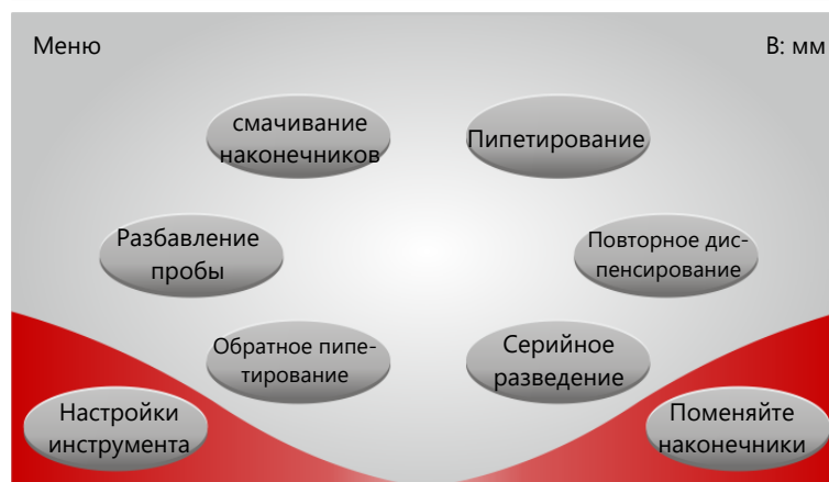
Изобр. 16 Главное меню с режимами пипетирования и расширенными функциями
